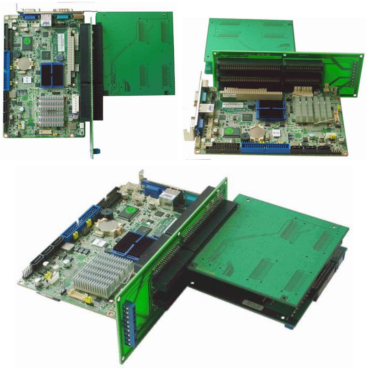
Рисунок 3. Варианты установки модулей в кросс-плату ВР-16.
